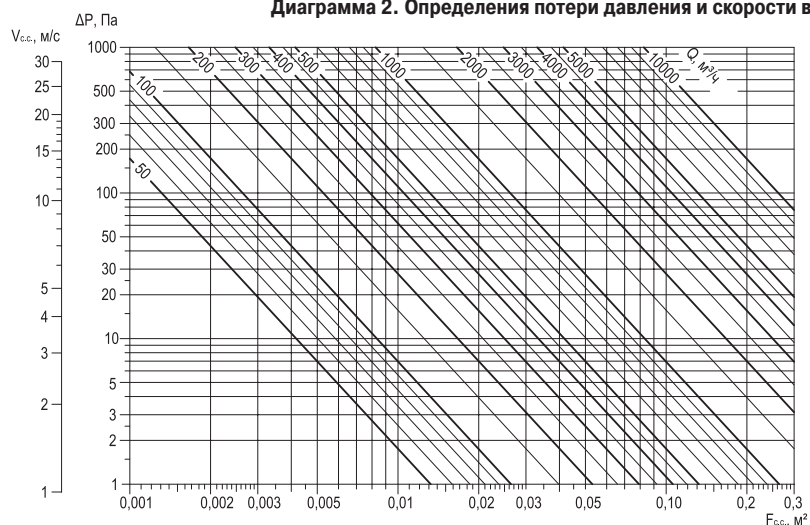
Диаграмма 2. Определения потери давления и скорости воздуха в свободном сечении диффузора
